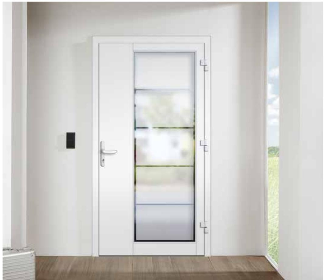
**A | Modell S0071** KLAUKE Connect**Schloßseitig:** beidseitig flügelüberdeckende Aluminium-Applikation**Bandseitig:** eingesetzte Verglasung 3-fach Ug 0,7 | **Glasmotiv 1****Außen:** VSG 6 mm | **Mitte:** Float vollflächig mattiert | **Innen:** Float 4 mm**Anwendungsbeispiel:** Stoßgriff 803800 auf der Aluminium-Applikation montiert**Oberfläche:** Flügel-/Rahmenkonstruktion RAL 9016
